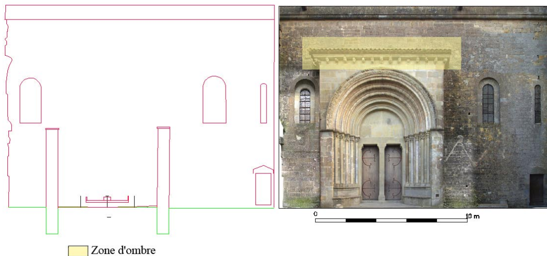
Figure 5 : Création d'une élévation à partir d'un dessin et du redressement de photographies.
