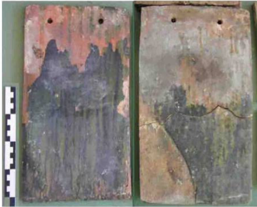
Fig. 5 : Sens (Yonne), cathédrale Saint-Étienne : tuiles sans crochet en provenance de la couverture. À g., le pureau est glaçuré d'une couleur unie ; à dr., le pureau est bicolore (cl. S. Aumard).
